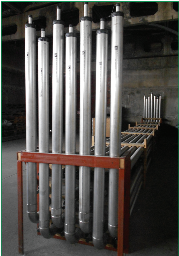
Рис. 4. Подготовленные к отправке секции криогенного трубопровода, изготовленного в 2014 г.
